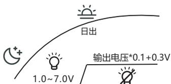
※ 1.光控点应设置为接近太阳能电池板开路电压0.1倍。
